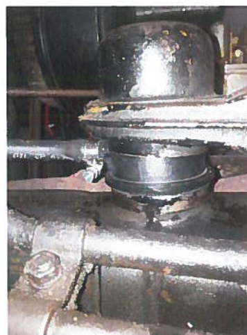
Der Rücklauf mit verändertem VW Adapter (ohne Eingriff in den Ventildeckel).
